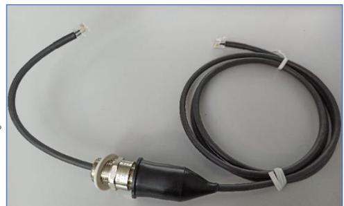
1. 小心地向後拉開觸電防護罩，以露出螺絲接頭。
