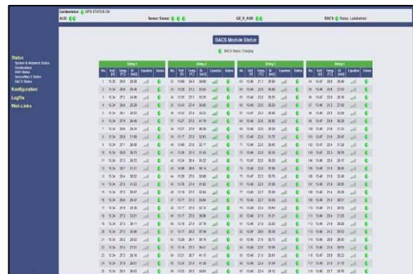
Der BACS®-Webserver zeigt den Batteriestatus von 140 Batterien, 16 Trockenkontakten, 8 analogen Messgeräten und 1 USV auf einem Bildschirm und einer Netzwerkadresse an. Status-LEDs (grün / gelb / rot) zeigen eine Farbänderung an, wenn eine Batterie die konfigurierten Schwellenwerte überschreitet.
