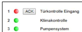
Zusätzlich blinkt auf der Stirnseite des Geräts die entsprechende LED langsam rot. Durch die Hold-Funktion bleibt dieser Alarm jedoch stehen, auch wenn der Türkontakt inzwischen wieder geschlossen wurde – er muss mit ACK - Button im Sensormonitor manuell bestätigt werden.
