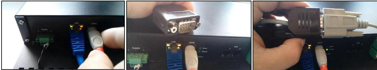
Um den korrekten Halt zu gewährleisten setzen Sie zwischen die kleinen beiden Arretierungen die im Lieferumfang enthaltenen Schraubmuttern.
