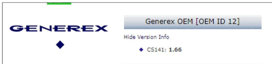
Mit dem Link *Show Version info* können Sie überprüfen, ob es eine aktualisierte Firmware als Download erhältlich ist. Beachten Sie, dass – anders als bei einem Update innerhalb derselben OEM-Firmware – der Wechsel der OEM-Firmware das Zurücksetzen auf Werkseinstellungen notwendig ist, da sich unter anderem auch die Funktionen ändern.
