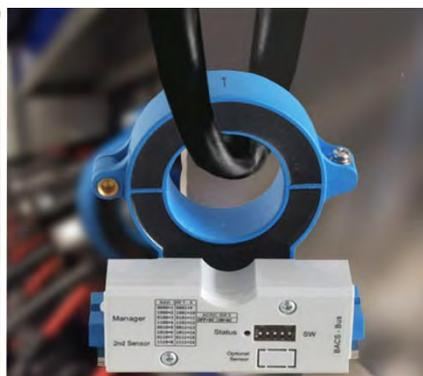
*Bild: Sensor der Generation 5 **CSHxxxxF/D** ohne DIN-Schienen-Clips wird frei hängen montiert.*
