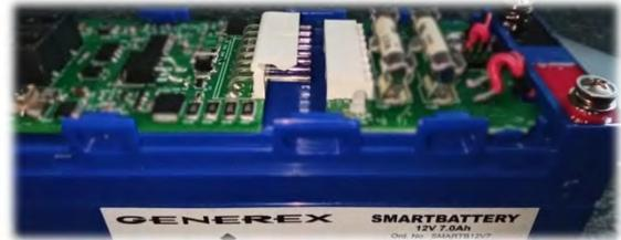
*Bild: SMARTBATTERY (in blau) mit integriertem SMARTLOGGER, Hochspannungssicherungen und Schnittstelle (ein 8-poliger Verbinder) zum „iBACS“-BACS-Modul zum optionalen Einschub in die SMARTBATTERY.*
