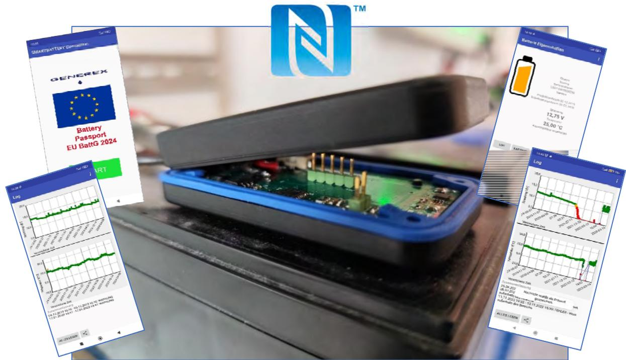
*Bild: Der SMARTLOGGER geöffnet mit Anschluss für externe NFC-Antenne - liefert als vollwertiges Offline-BMS per NFC ein umfassendes Bild über den Einsatz der Batterie seit Produktionsdatum bzw. Kommissionierung und erfüllt damit sowohl die Vorgaben des EU BattG 2024 als auch die des DSGVO (Datenschutz). Alles, was Sie benötigen, ist die SMARTLOGGER Companion App, welche kostenfrei im Google Play Store zum Download verfügbar ist.*
