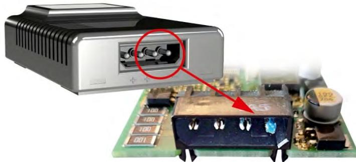
**Unsere Untersuchungen haben ergeben, dass die BACS-Module (und auch alle Anschlusskabel) mit einem basischen Elektrolyten kontaminiert waren.**
